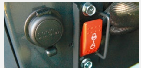
Elektrische Motorabschaltung (Nothalt)
