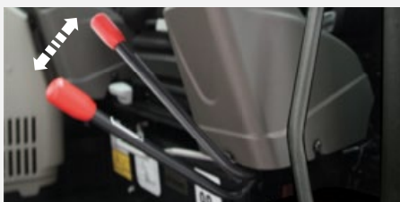
Sicherheitshebel, um zum Fahrerstand zu gelangen
