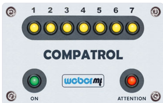
COMPATROL®-CCD meldet: „Verdichtung abbrechen, maximale Verdichtung erreicht“.
