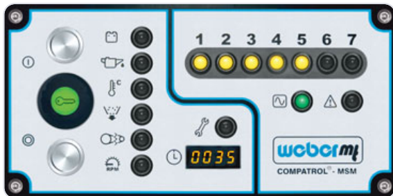
COMPATROL®-MSM: Display-Anzeige während der Verdichtung.
