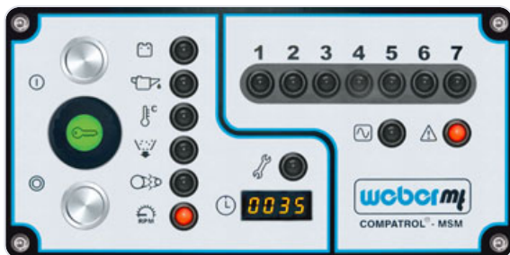
COMPATROL®-MSM zeigt an: Motordrehzahl nicht in Ordnung. Ursache überprüfen. Verdichtungsmessung nicht möglich.
