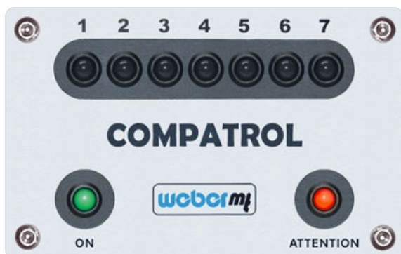
COMPATROL®-CCD zeigt einen Fehler an: „kein tragfähiger Untergrund, Boden ist nicht zu verdichten.“
